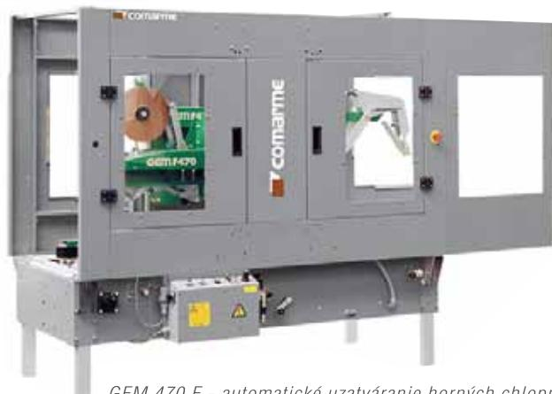
GEM 470 F - automatické uzatváranie horných chlopní
